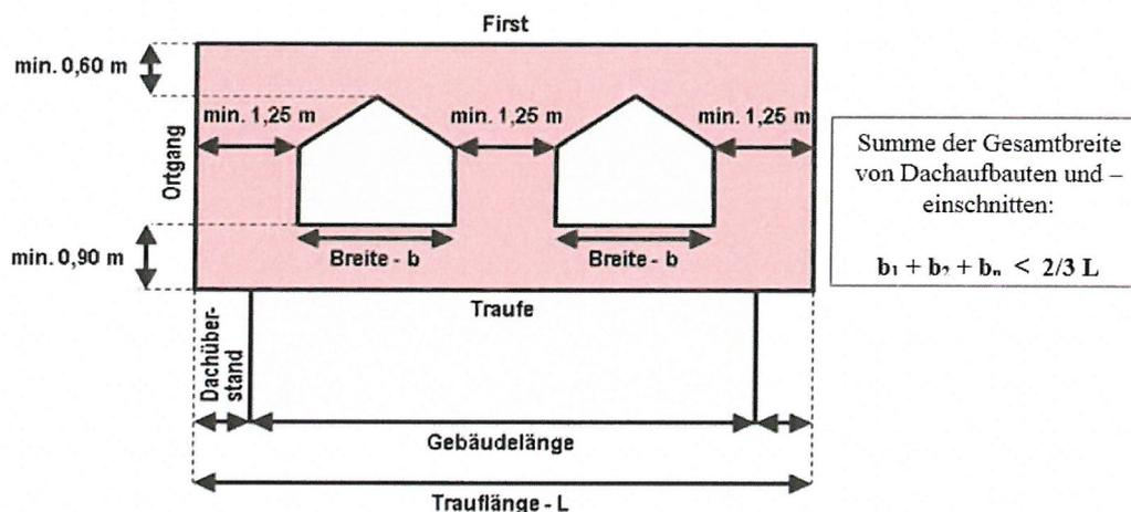
Abbildung 5: Abmessungen zulässiger Dachgauben (hier Beispiel: Sattelgaube)
