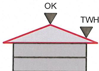
Abbildung 1: Bestimmung der zulässigen TWH und OK am Beispiel Satteldach
